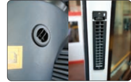
Çok noktadan ısıtma ve soğutma sistemi
