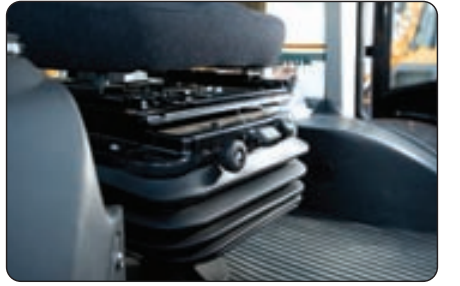
Operatörün ağırlığına göre esnekliği kompresör havasıyla ayarlanabilen, terlemeyi önleyen operatör koltuğu.
