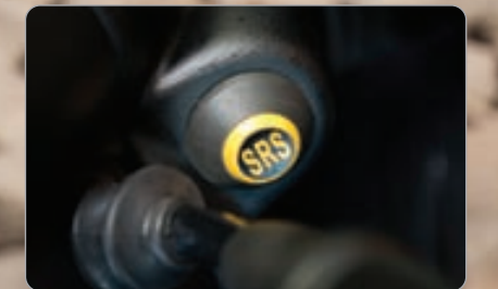
SRS: Operatör konforu için sarsıntısız yürüyüş sistemi (opsiyonel)
